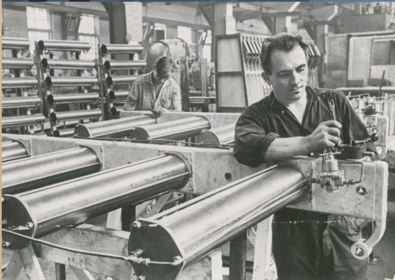
Слесарь-сборщик Б. Лазько и слесарь В. Афанасьев за сборкой цилиндров новых прессов на Ростовском машиностроительном заводе (1975). ЦДНИРО. Ф.Р-3619. Оп.7. Д.619
